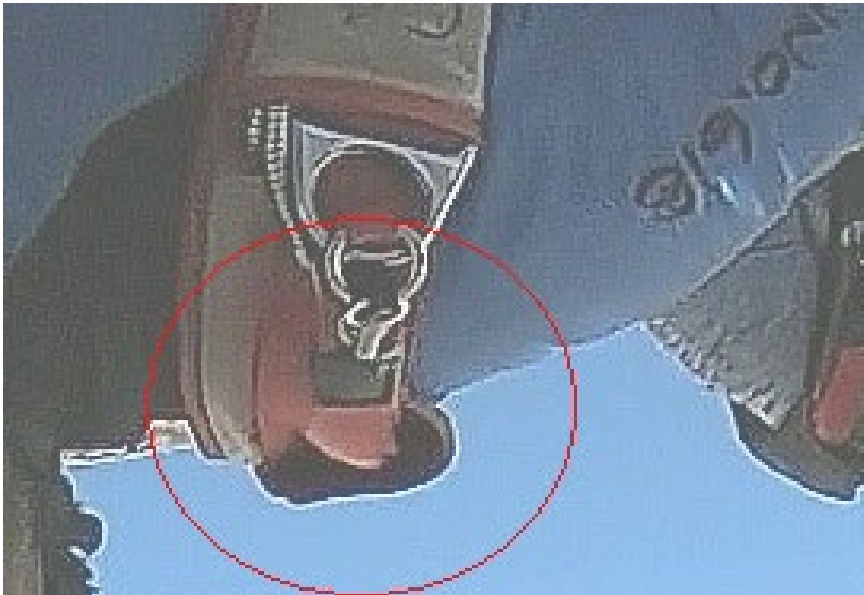
Bild 5: Bärremsskydd stängt, men på väg att "ta luft" och öppnas.
