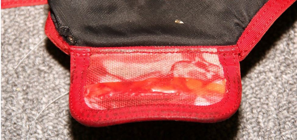
Bild 3: Bärremsskyddets tuck tab modifierad med plastmassa typ Shoe Goopolise
