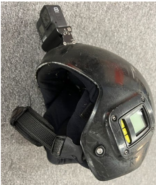
Bild 1: Hjälms med GoPro och akustisk höjdvarnare
