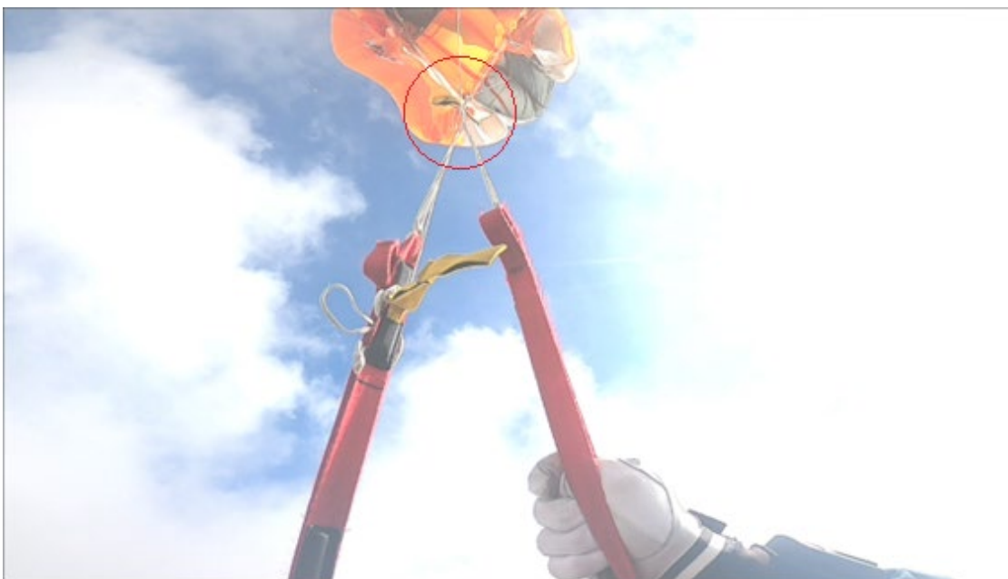
Bild 9: Huvudfallskärm med snodda bärlinor och lossat chockbroms omedelbart efter drag.
