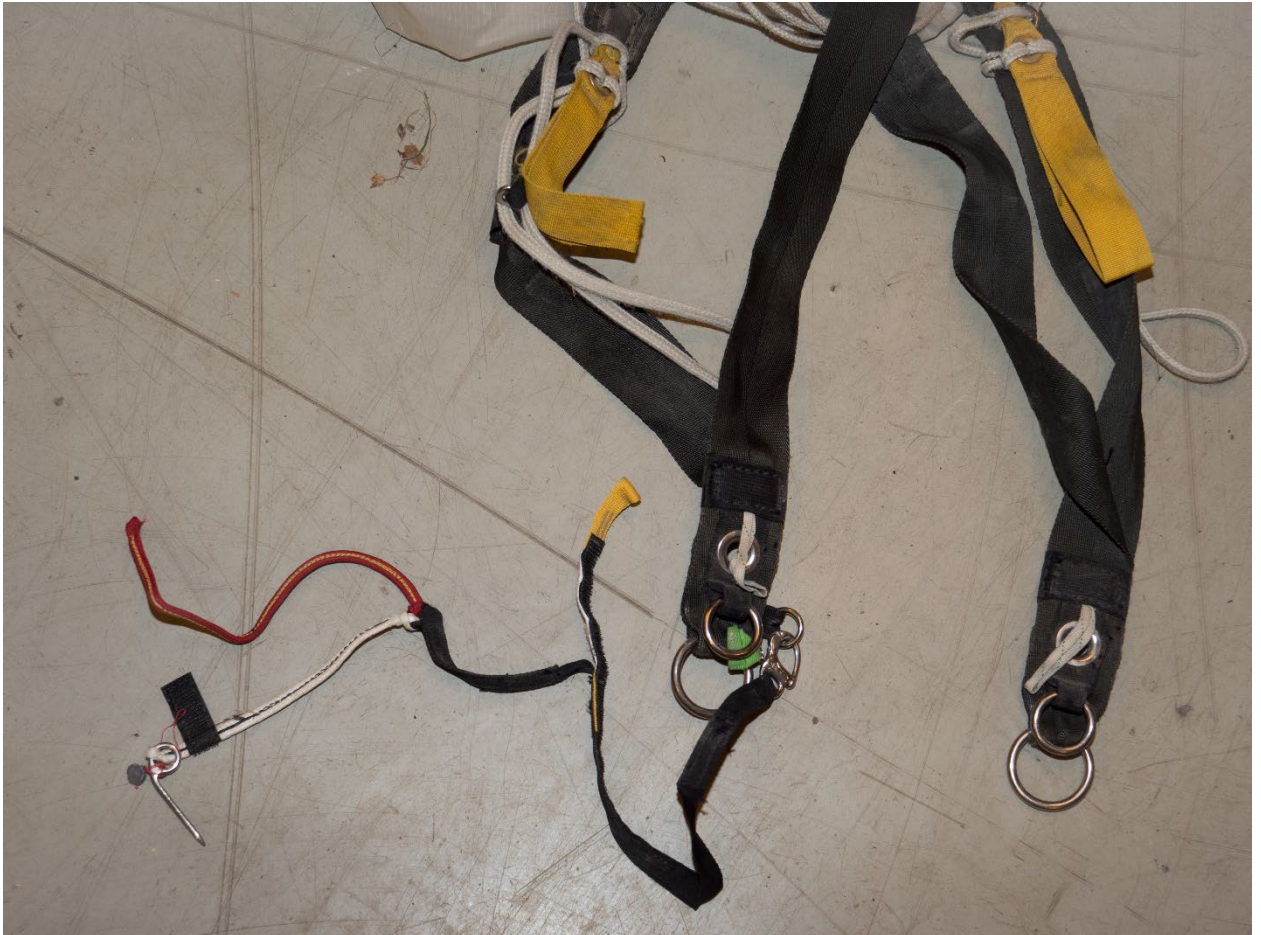
Bild 3. Huvudkalottens bärremmar med parkerade styrhandtag och Skyhook-linor.
