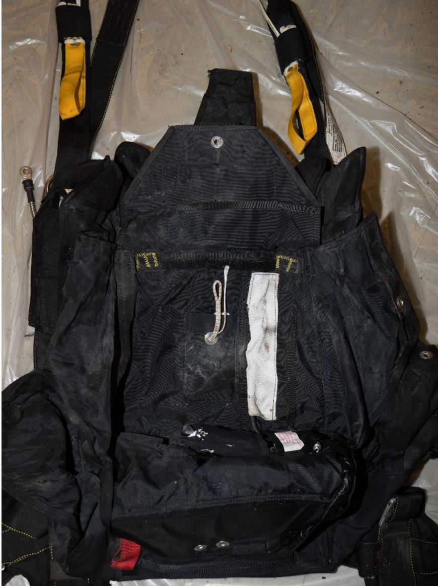
Bild 4. Reservcontainer med intakt reservloop och staging loop.
