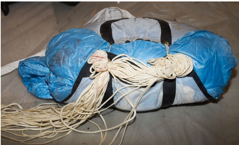
Bild 8. Freebag med intakt reserv och linslag kvar i safety stow loopen.
