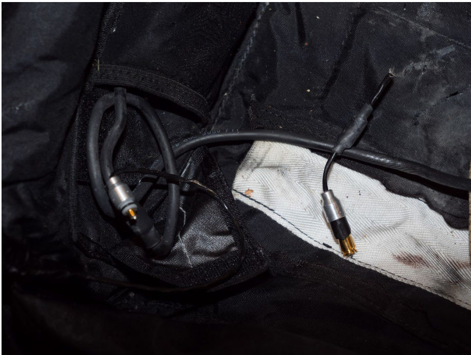
Bild 11. Ledningar och anslutningar till räddningsutlösaren är avslitna eller sönderslagna.
