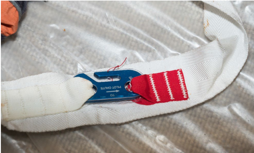
Bild 7. Skyhook på reservens pilotlina med bruten plombtråd.
