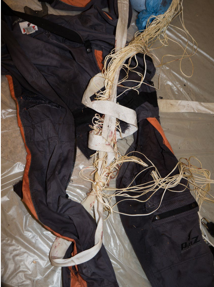
Bild 9. Trasslade bärlinor och pilotlina.
