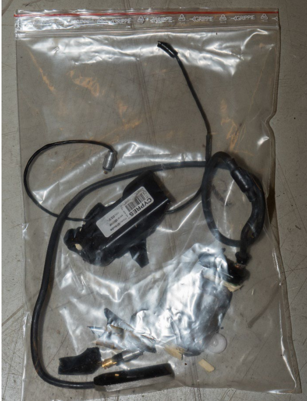
Bild 12. Återfunna delar av räddningsutlösaren.
