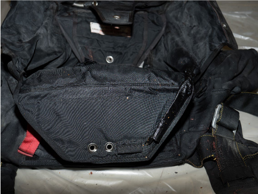
Bild 10. Räddningsutlösarens cutter saknas.
