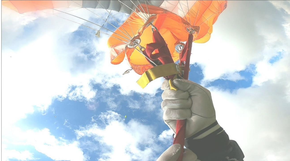
Bild 16: Bärremmarna snodda. Ett styrhandtag i bromsat läge och ett lossat.
