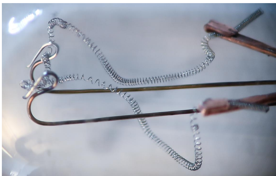
Figur 42. Förstoring av bild på lampan för stallvarning. Bilden visar den deformerade glödtråden.
