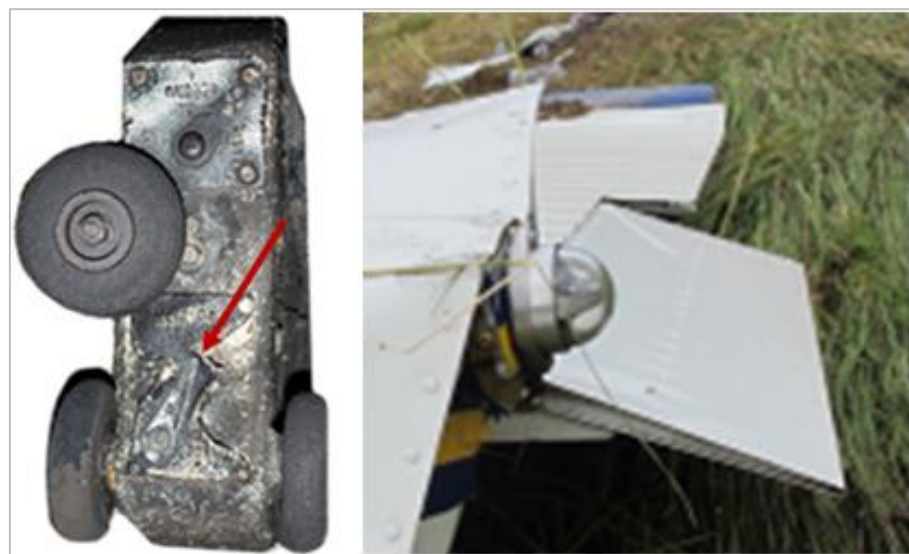
Figur 25. Vänster bild visar trimpanelen där pilen visar inställd position på höjdrodertrimmens indikator. Höger bild visar motsvarande läge på höger höjdroder.
