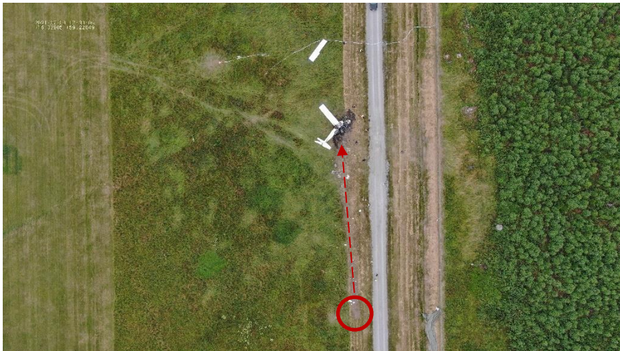
Figur 23. Nedslagsplatsen markerad med röd ring och flygplanets slutliga position.
