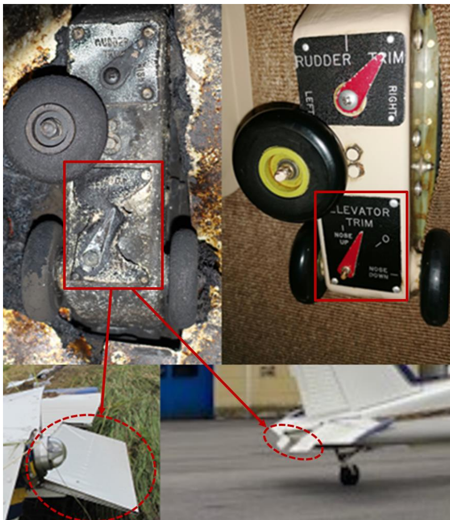
Figur 30. Bilderna visar höjdrodertrimmens indikering och position före och efter olyckan. Nedre bilden till höger: Privatperson.
