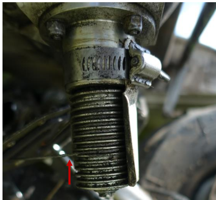
Figur 32. Höjdtrimroderlinans position och anslutning på kabeltrumman.
