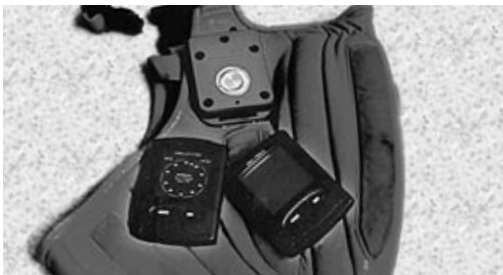
Tre modeller av ljudhöjdvarnare: från enklaste typen som ger signal på inställd höjd, till mer avancerade som även "minns" och anger olika data om frifallet såsom hastigheter och frifallstider.
