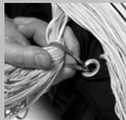
Lösa eller nötta gummiband kan göra att linslagen öppnar i fel ordning eller ojämnt.
