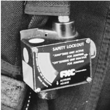
Två modeller av räddningsutlösare: FXC12 000 och Cypres.
