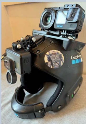
Inte snagfree men losskopplingsbar hjälm. Utstickande delar, vassa kanter, stor kamera. EJ GODKÄND för hoppning som en del i genomförande av hoppet. ENDAST GODKÄND för kameraflygning.
