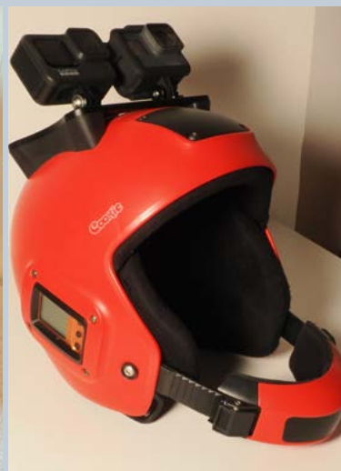
Inte snagfree men losskopplingsbar hjälm. Utstickande delar, vassa kanter, stor kamera. EJ GODKÄND för hoppning som en del i genomförande av hoppet. ENDAST GODKÄND för kameraflygning.
