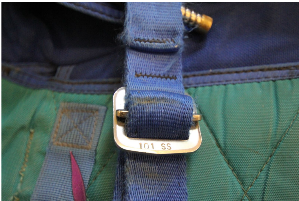
Bild 8) Skada på bröststremmens webbing.
