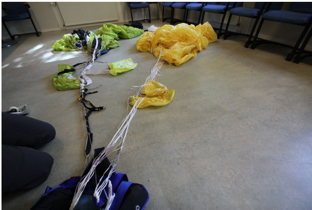
Bild 3) Huvudskärm och reservskärm har roterats upp. Pilotlinan för reservpiloten sitter fortfarande roterad runt huvudkalottens bärlinor. Reservfallskärmens bärremmar löper ner och runt huvudcontainerns toppflik.
