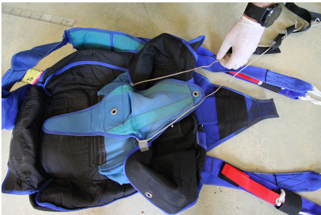
Bild 5) Centerlinan för främre bärrem på vänster (hopparen sett) sida löper fortfarande under huvudcontainerns toppflik. Linan bedöms utgöra en upphängningspunkt och orsaken till att huvudskärmen inte lossnat helt från utrustningen vid losskoppling.
