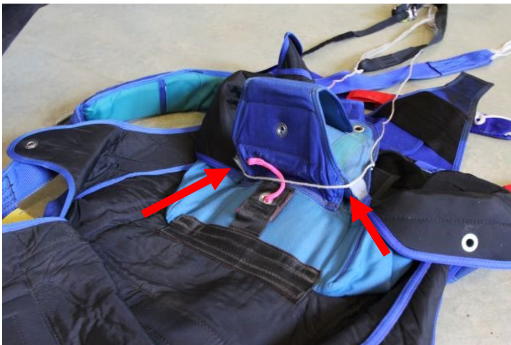
Bild 1. Bilden visar utrustningen vid teknisk besiktning, upphakade linan är tydligt synlig, pilarna visar "hörnerna" på fliken den blivit upphakad i.
