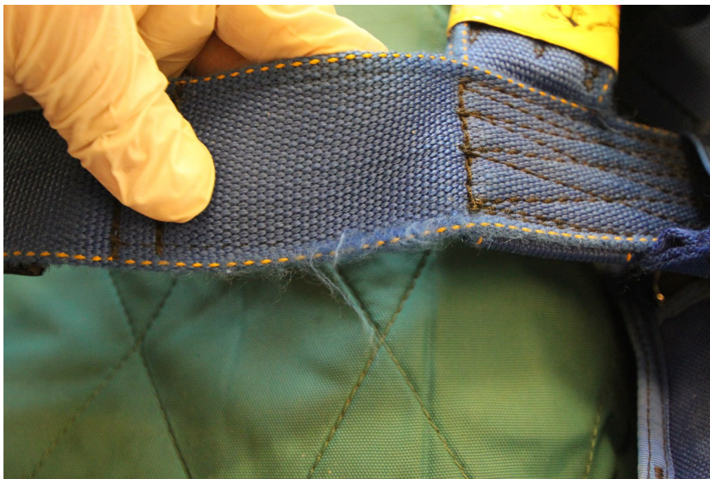
Bild 9) Förhöjt slitage på vänster (hopparen sett) basrem närmast benrem.
