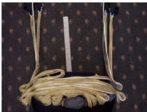
Bild 4: Från servicebulletin #08325 rekommenderad instruktion för linuppfästning med gummiband på bagens sidor.
