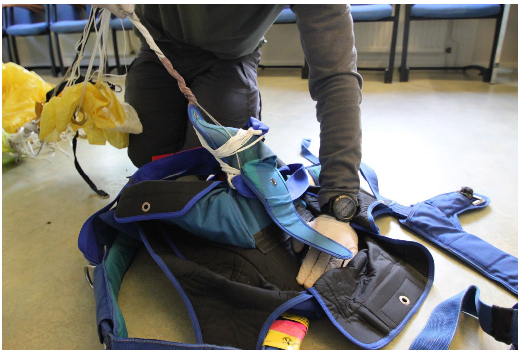
Bild 2) Huvudskärmens och reservskärmens bärlinor är sammantvinnade och sitter fast runt huvudcontainers toppflik och reservcontainers bottenflik.
