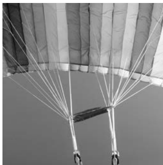
Slidern har stannat en bit upp på bärlinor.
