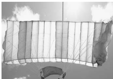
Inblåsning. Höger yttercell är inte luftfylld utan slår i vinden.
