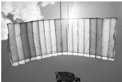
Två av de främre bärlinorna i centrum har brustit.
