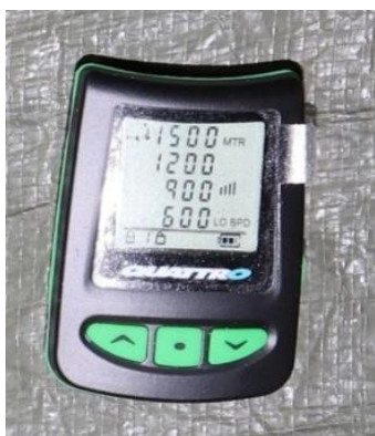
Bild 4: Akustisk höjdvarnare L&B Quattro
