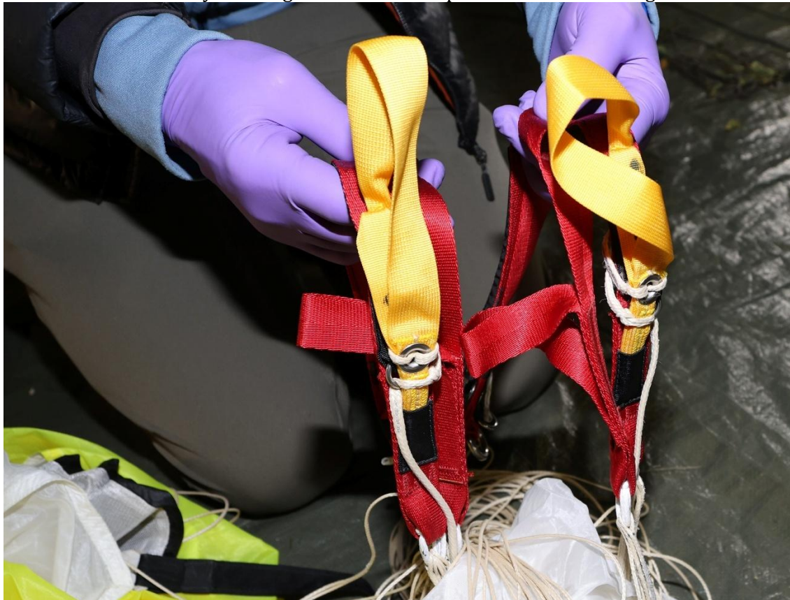
Bild 26: RS styrhandtag. Bild från polisens undersökning av utrustningen.
