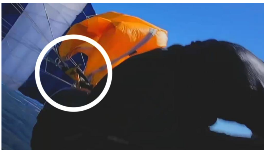
Bild 21: Vänster styrhandtag lossat från styrhandtagshållare s.k. "togglefire"
