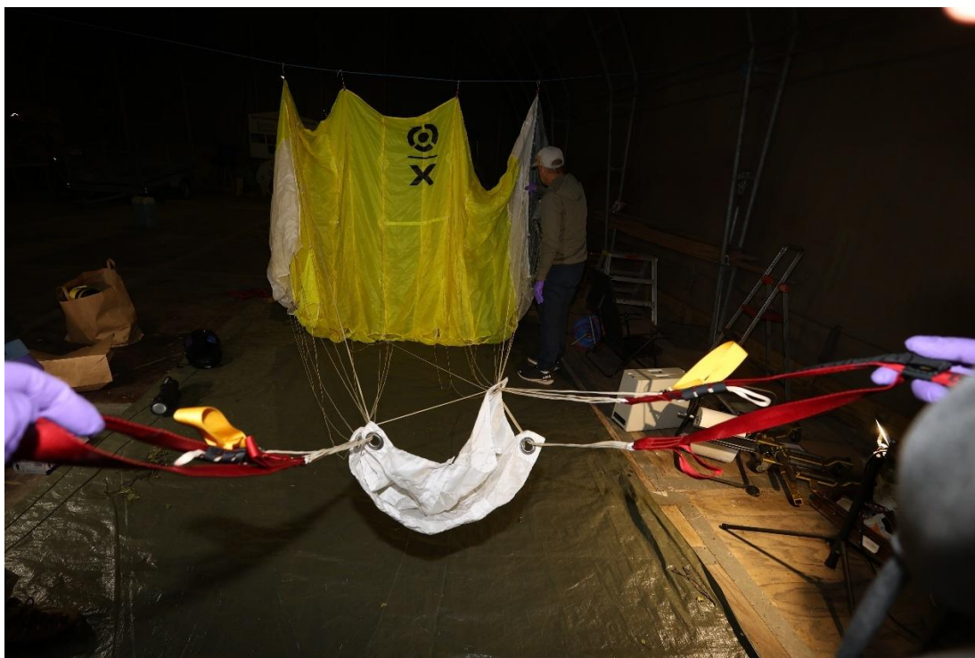
Bild 29: Från teknisk undersökning, visar lina som korsar höger bakre lingrupp
