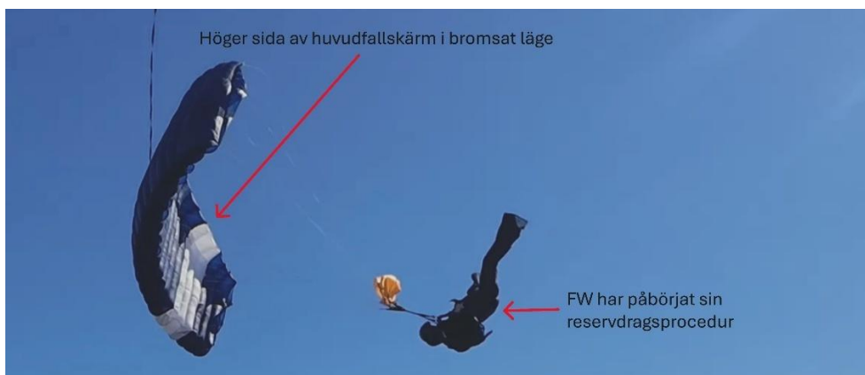
Bild 18: Öppningsförlopp 2, huvudfallskärmen dyker och roterar kraftigt medurs. FW har påbörjat reservdragsprocedur.
