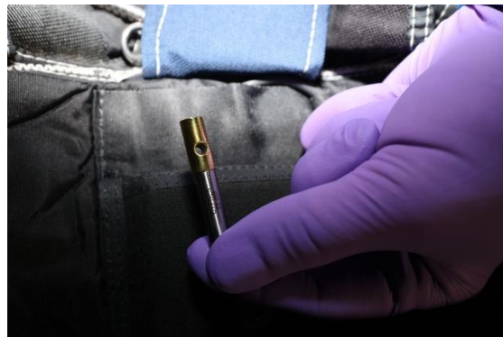
Bild 28: AAD enhetens "cutter"-ej aktiverad
